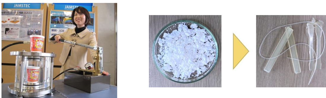
図 1. （左）~1,000 気圧までの高压を発生できるハンドポンプ。（右）室温でのプラスチックの成形加工。粉末状のバロプラスチックを室温・500 気圧で溶融させ、様々な成形品を製造可能です。
