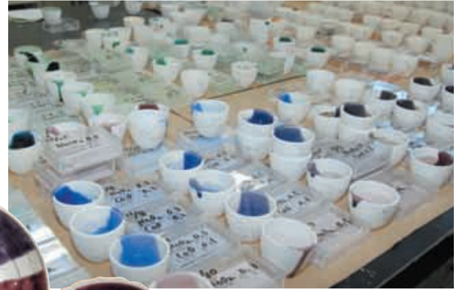
ひび割れ解消のため、構成成分を試行錯誤する
