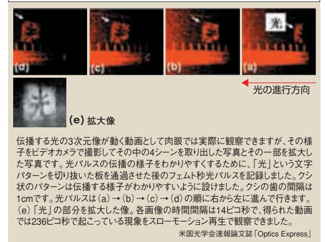
図3 広げて平行光にしたフェムト秒光パルス伝播の3次元像の記録・観察結果
