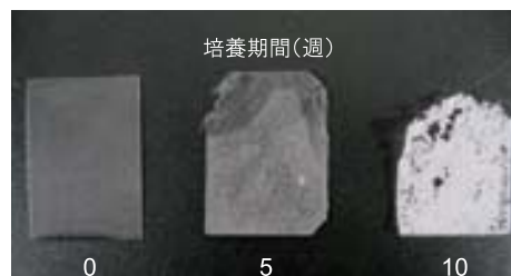
微生物分解によってPETフィルム表面に微細な穴が多数開き、最終的には分解されて消失する
