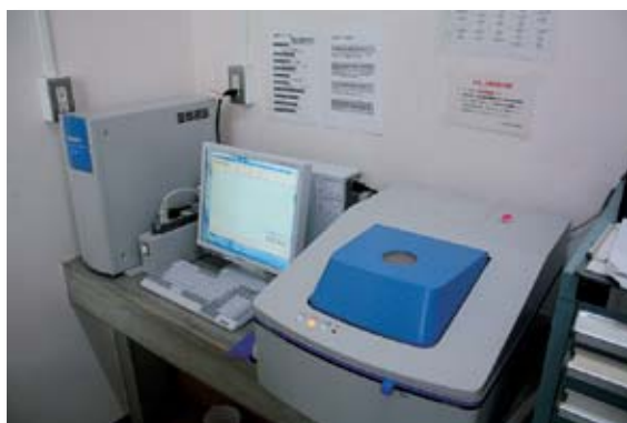
廃液中の硫黄、塩素濃度の測定
