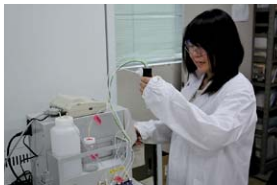
還元気化原子吸光法による水銀分析
