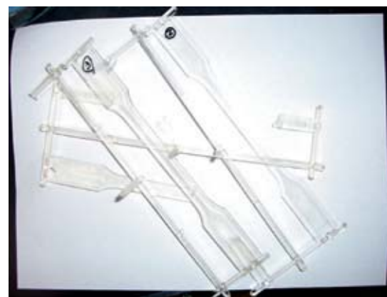
図3 ジステレオブロック型ポリ乳酸の射出成形物
