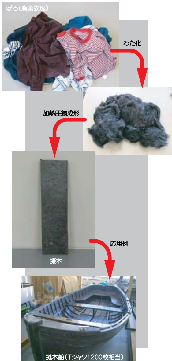
図2 ぼろ(一廃)を用いた擬木の成形
