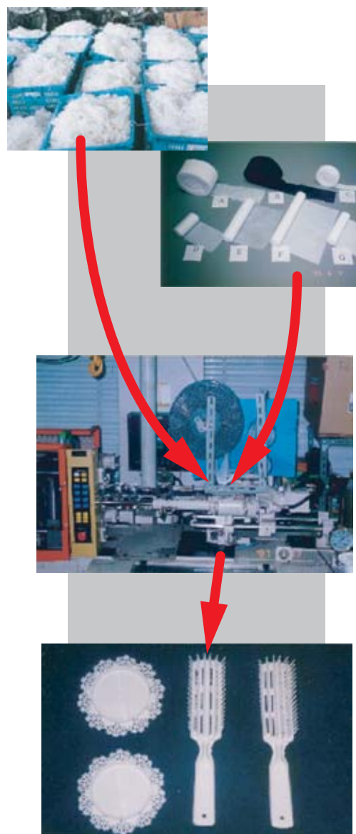
図1 合成繊維屑（産廃）を用いたプラスチック製品の射出成形
